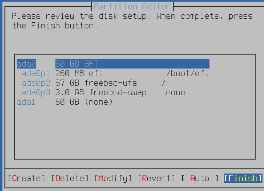
Figure 15. Vérification des partitions créées
